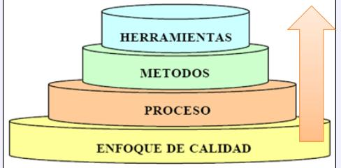
Fig. 2.1. Capas de la ingeniería del software
